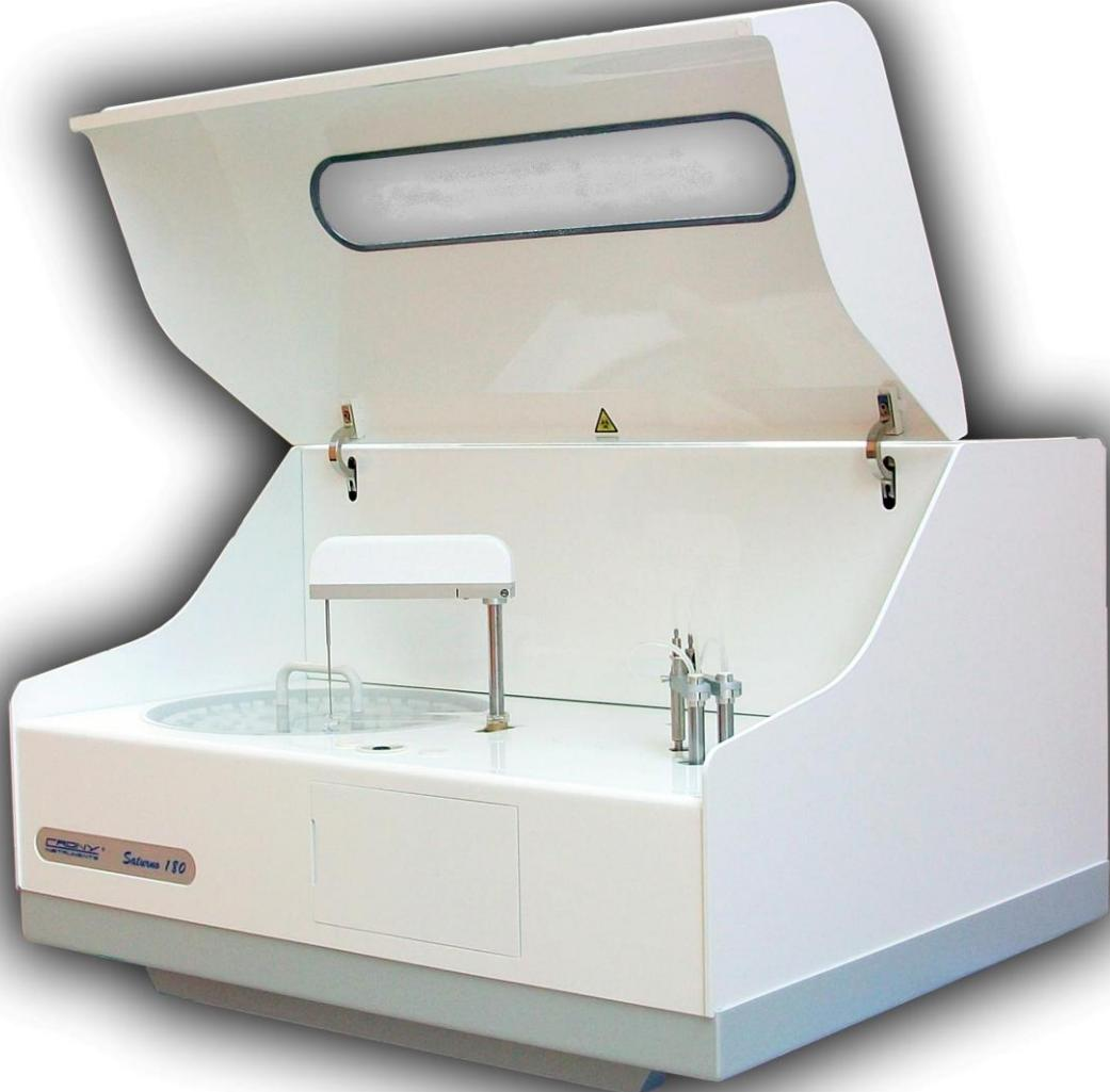
**Saturno 180** este un analizor de biochimie ce utilizeaza tehnologiile de ultima generatie. Foloseste un software usor de utilizat, cu operatiuni simplificate si este dedicat laboratoarelor mici si medii.
